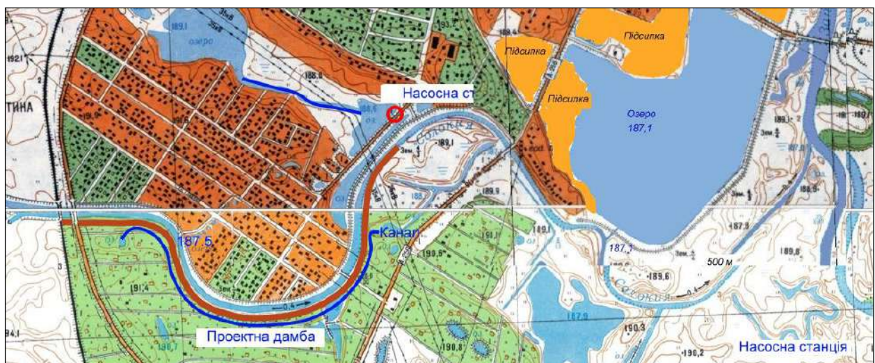
Рис. 7.7. Правобережна захисна дамба на р. Солокія.
